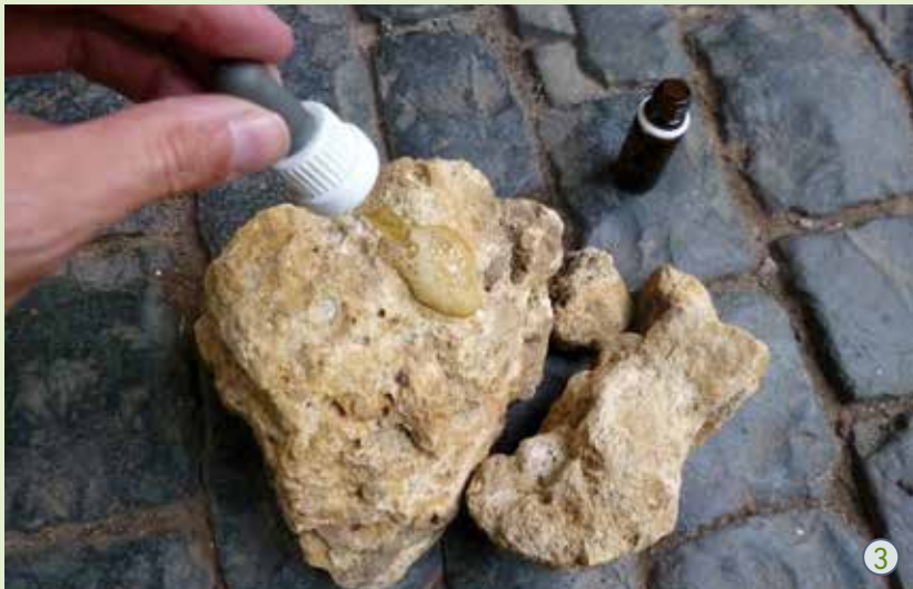
Kalk aus der Metz. Kalk wird abgelagert, wenn viel Wasser verdunstet. Er sprudelt mit 10%iger Salzsäure (Kalktest).
